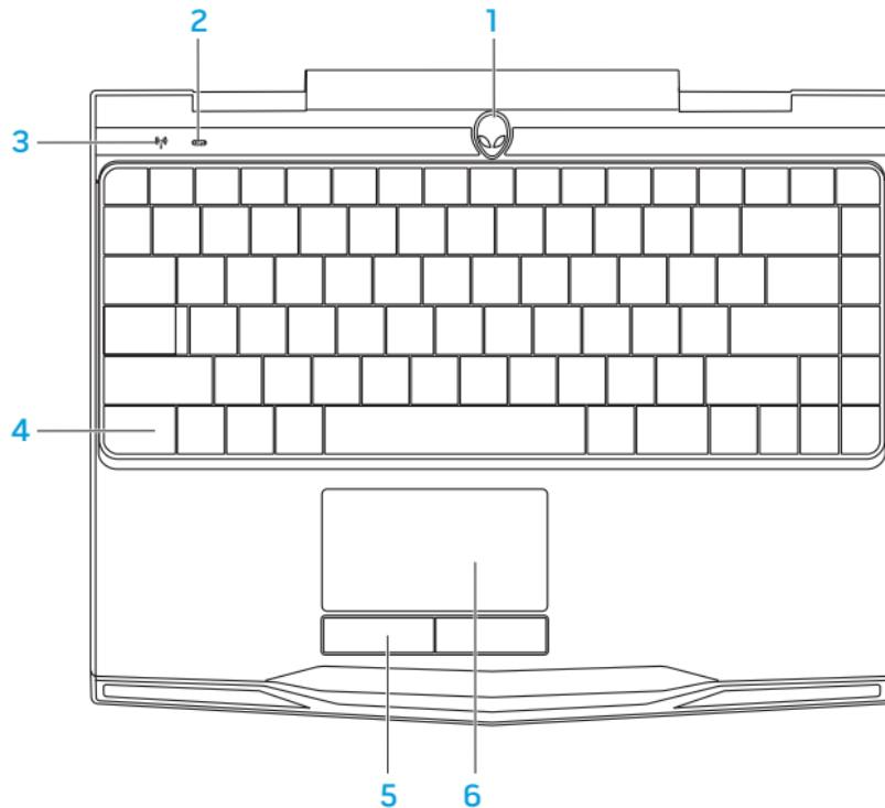
1 **Av- og på-knapp** — slår datamaskinen av eller på. For mer informasjon, se "Av- og på-knapp" på side 32.
